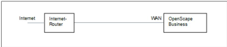
Dazu nutzen Sie den WAN-Anschluss des Kommunikationssystems. OpenScape Business kennt entweder den Internet-Router oder arbeitet als DHCP-Client. Diese Möglichkeit kann verwendet werden, wenn der Internet-Router in einem anderen Netzsegment liegt und einen eigenen DHCP-Server hat.
